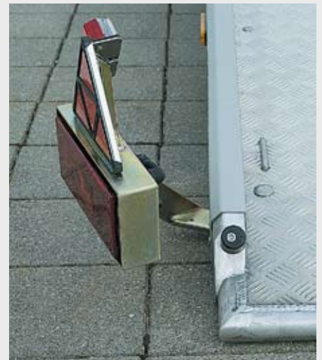
Die Leuchten schwenken beim Beladen automatisch nach außen und sind dennoch für den nachfolgenden Verkehr gut sichtbar.
