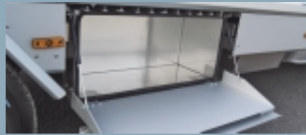
Wasserdichtes Schließfach für Werkzeug und Sicherheitsausrüstung.
