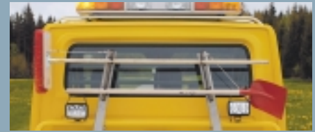
Schnell zur Hand und bestens verstaut Geräteträger mit Schaufel und Besen.
