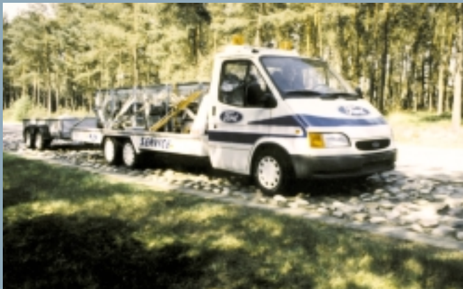
1.000 km Langzeittest mit 4.450 kg Beladung auf dem Schlechtwegparcours des Testgeländes von Ford. Mit Auszeichnung bestanden!
