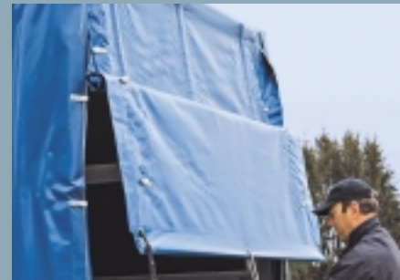
Heckplane mit Aufrollautomatik
