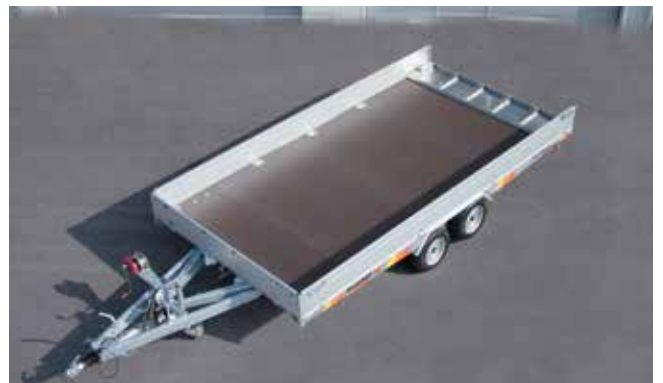
Heckklappe optional nach innen umlegbar. Somit können Luftwiderstände während der Fahrt vermieden werden.
